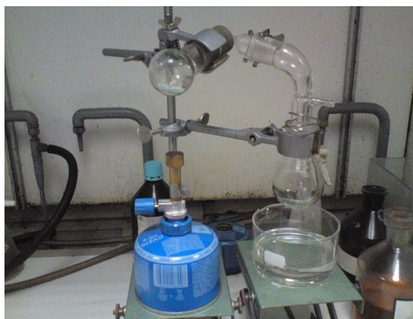
Fig. 3 Apparecchiatura usata per la distillazione del vetriolo verde ( $\text{Fe}_2(\text{SO}_4)_3$ ).
